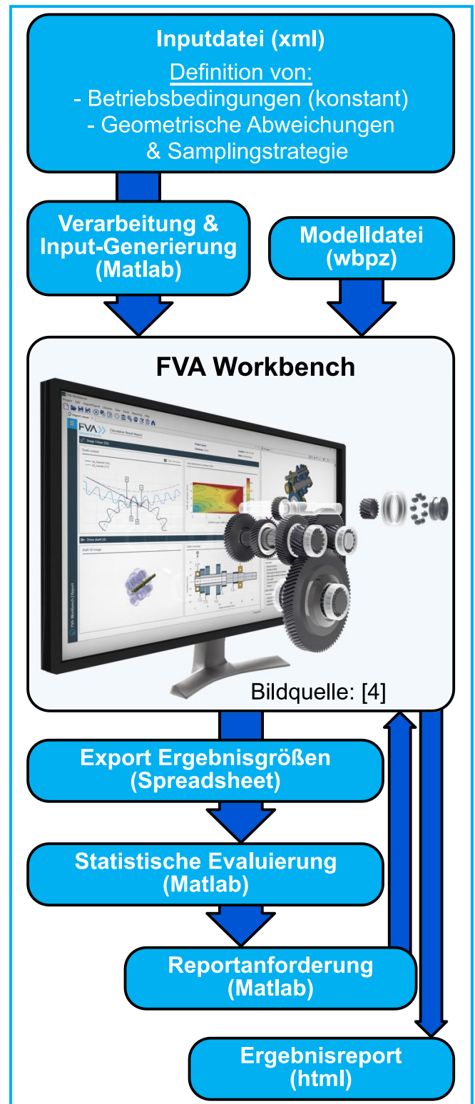
03 Ablauf der statistischen Toleranzanalyse bei der Wälzlagerberechnung mit FVA Workbench
